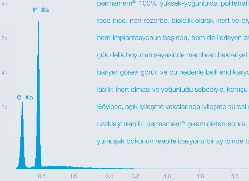
permamem® in Energy-dispersiv X-ray spektroskopisi (EDX) : moleküler parmak izi. Karbon ve florinin karakteristik pikleri. Tespit edilen başka bir faz yok
